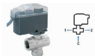
Valvola deviatrice 3 vie per la produzione di acqua calda sanitaria (230 ~, attacchi F-F 1")
